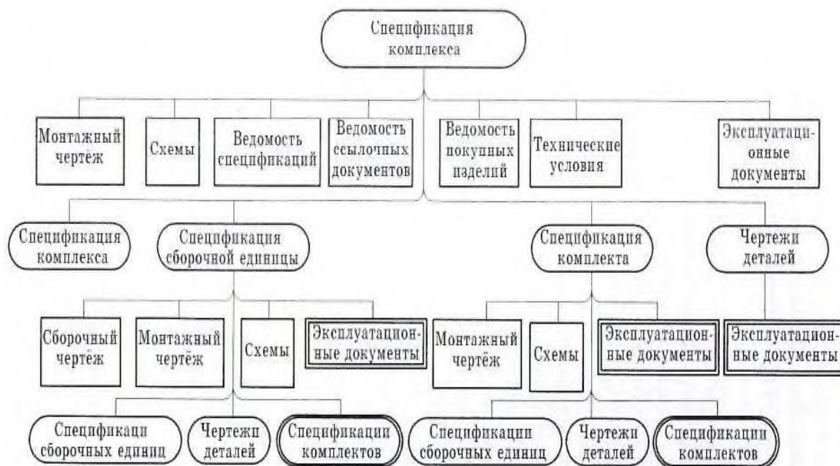
Рисунок 2 – Пример построения полного комплекта конструкторских документов комплекса [7]
