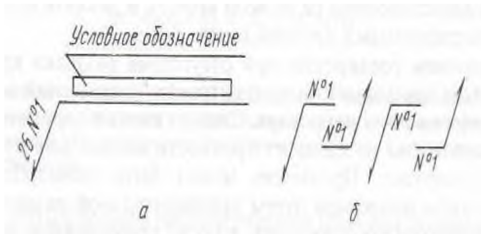
Рисунок 13 – Обозначения на чертежах одинаковых швов [11]
