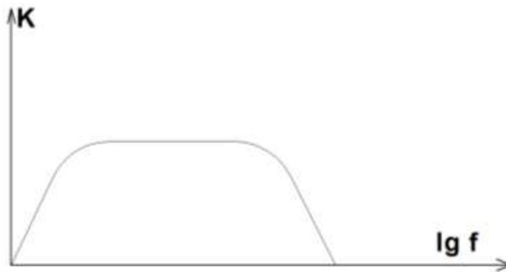
Рисунок 1.3 – АЧХ многокаскадного усилителя
