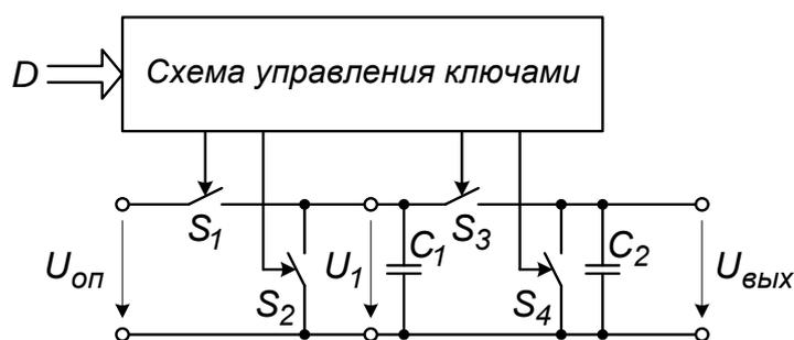
Рисунок 1.3 – Функциональная схема цифро-аналогового преобразователя на переключаемых конденсаторах
