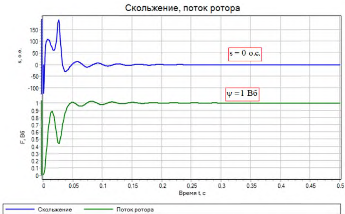
Рисунок 60 – Графики скольжения и потока ротора
