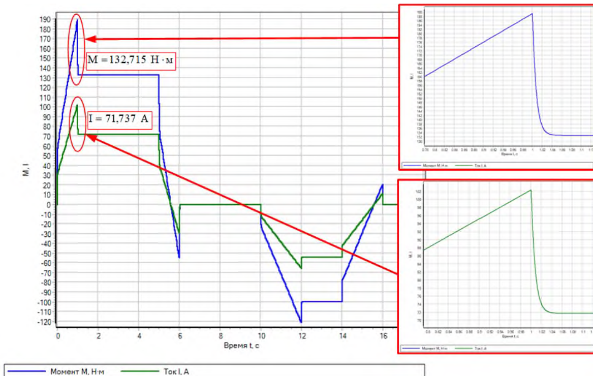
Рисунок 32 – Зависимости тока и момента от времени «Блока ЭМП»
