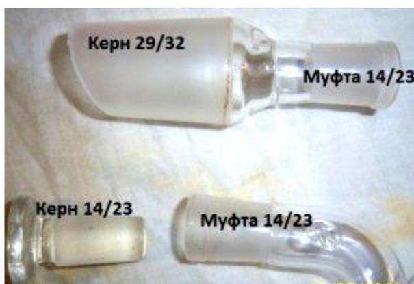
Рисунок 2.18 – Конусные шлифованные соединения
