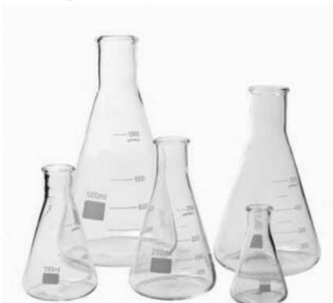
Рисунок 2.4 – Колбы конические Эрленмейера
