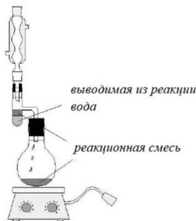
Рисунок 4.2 – Установка для синтеза дибутилового эфира с ловушкой для воды
