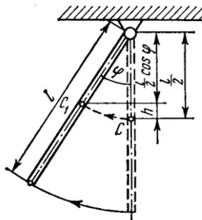
Рисунок 13 – Отклонение стержня при попадании пули
