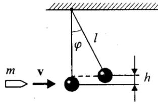
Рисунок 10 – Отклонение шара при попадании в него пули
