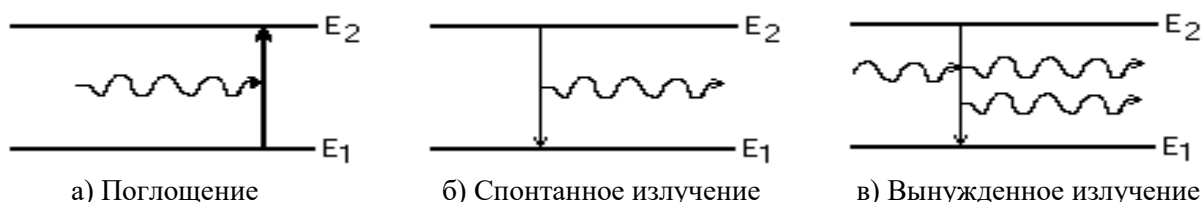
Рисунок 16 – Схема спонтанного и вынужденного излучения атомов
