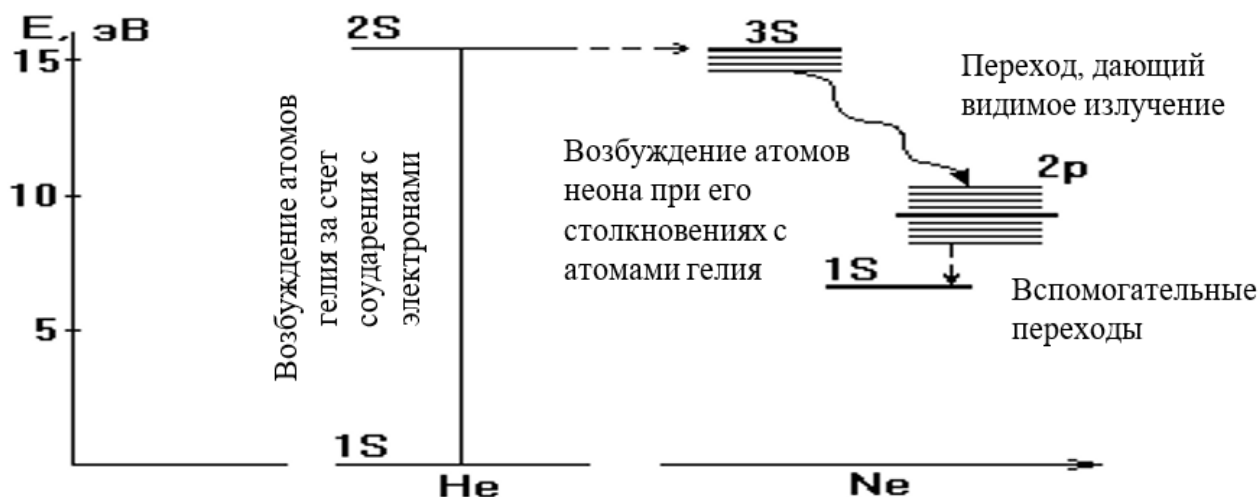
Рисунок 19 – Схема энергетических уровней атомов гелия и неона
