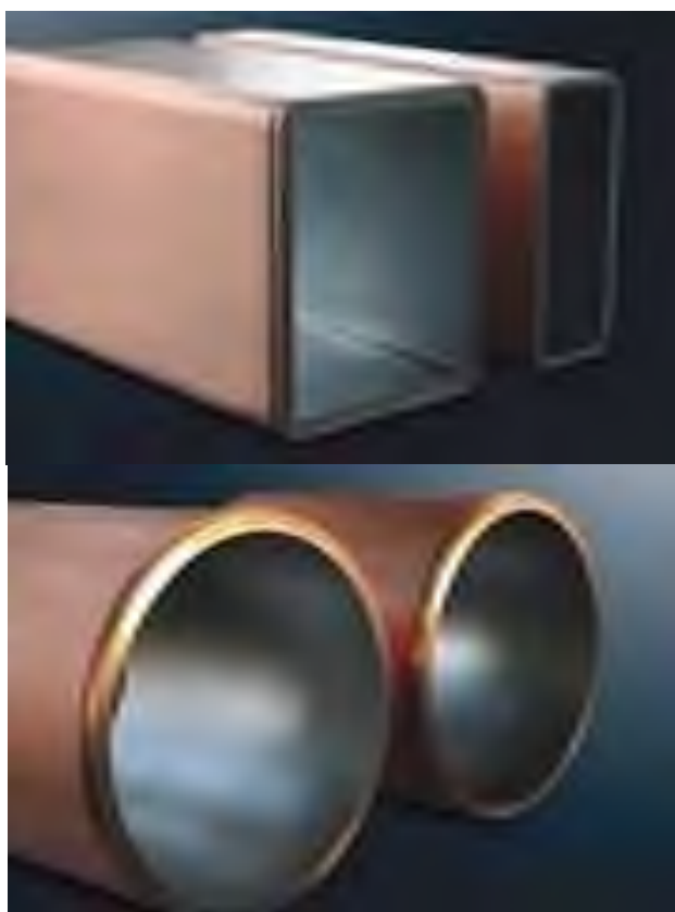
Рис. 7.3. Внешний вид гильзовых кристаллизаторов прямоугольной (слева) и круглой (справа) формы
