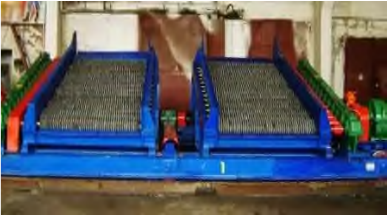
Рис. 7.9. Сдвоенный 14-ти валковый грохот для сортировки кокса с групповым приводом с зубчатыми передачами
