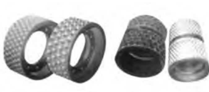
Рис. 8.19. Сплошные кольцевые бандажи валкового брикетного пресса
