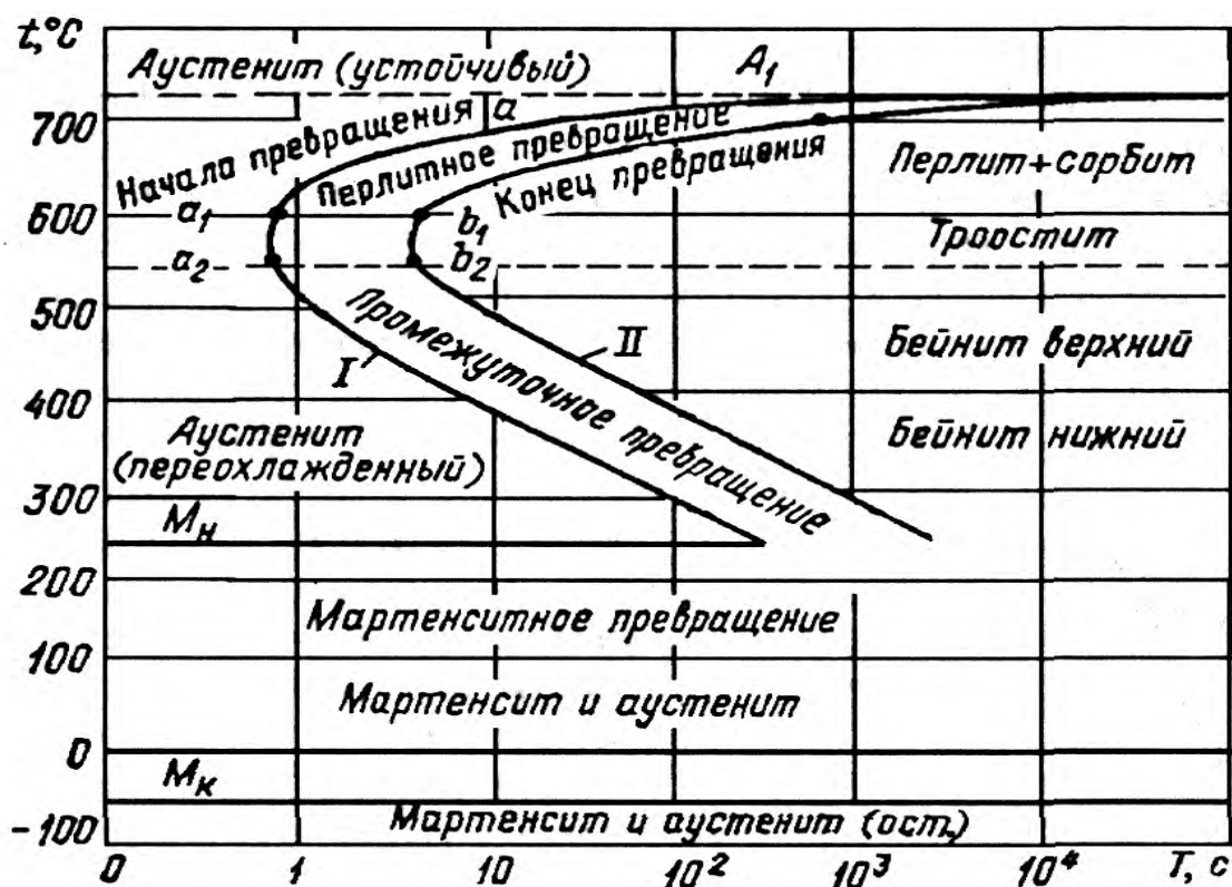
Рисунок 9.2 – Диаграмма изотермического превращения аустенита стали, содержащей 0,8 % углерода
