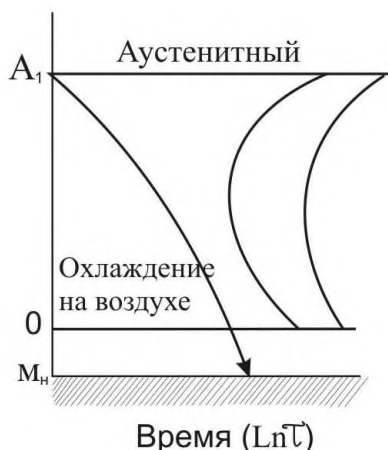
Рисунок 6.7 – Диаграмма изотермического распада аустенита различных классов сталей аустенита
