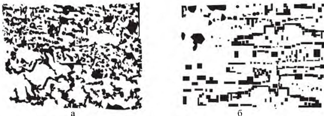
Рисунок 11.2 - Микроструктура сплавов типа Д в отожженном (а) и искусственно состаренном состоянии (б)
