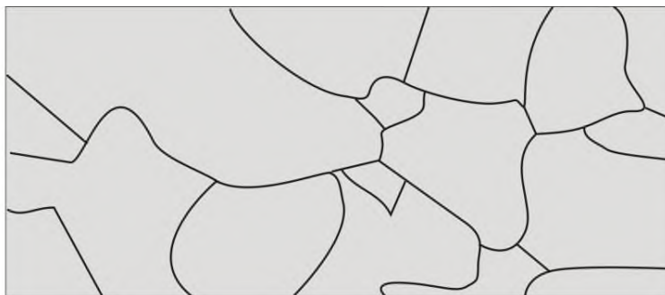
Рисунок 2.1 – Границы зёрен чистых металлов и твёрдых растворов
