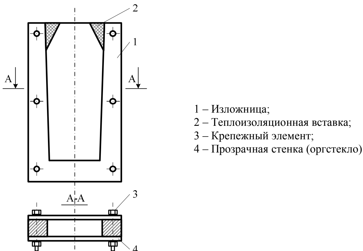
Рисунок 1.2 – Модель плоской прозрачной изложницы
