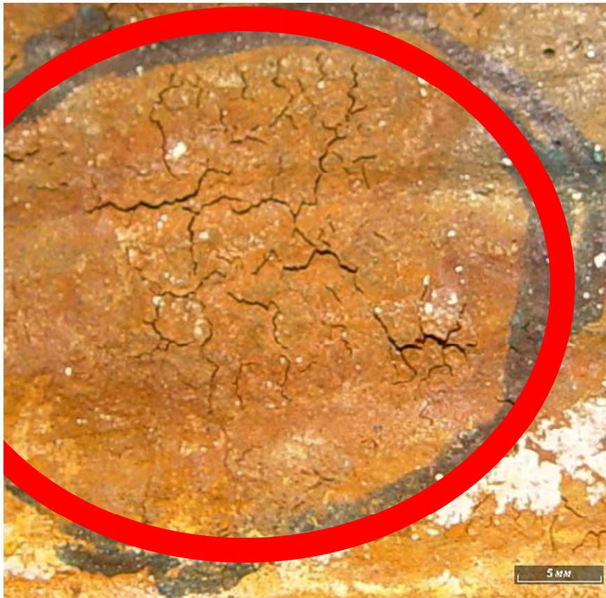
Рисунок 6.7 – Макрофотография дефекта «Паукообразная трещина»
