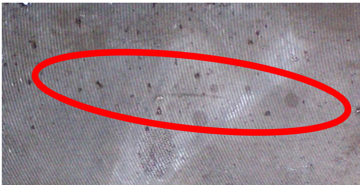
Рисунок 6.11 – Макрофотография дефекта «Точечная неоднородность»
