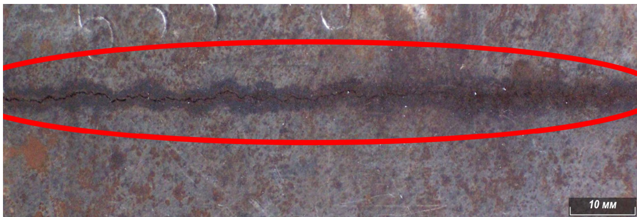
Рисунок 6.4 – Макроструктура дефекта «осевая трещина»
