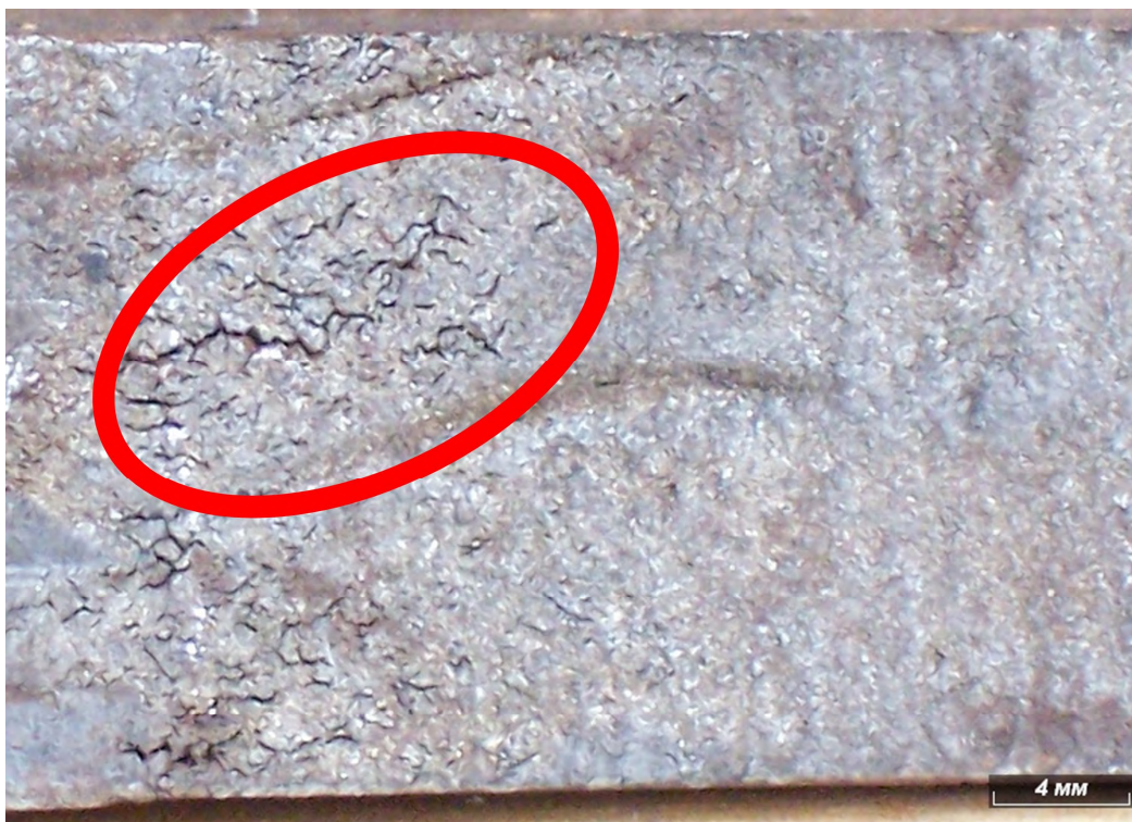
Рисунок 6.8 – Макрофотография дефекта «Сетчатая трещина» на слябовой заготовке
