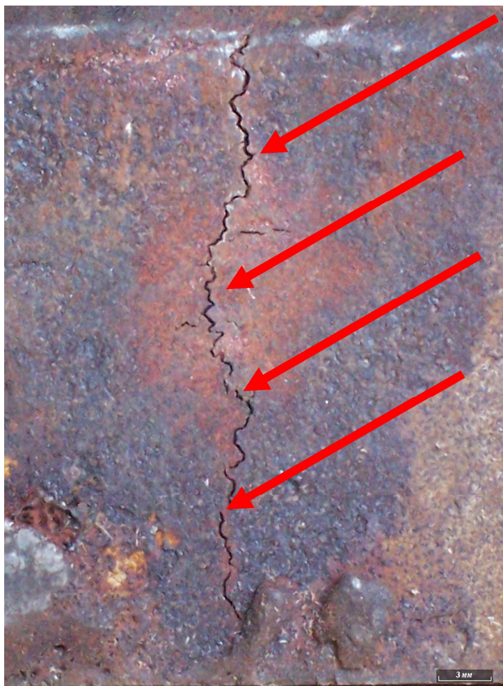
Рисунок 6.5 – Макрофотография дефекта «Продольная трещина»
