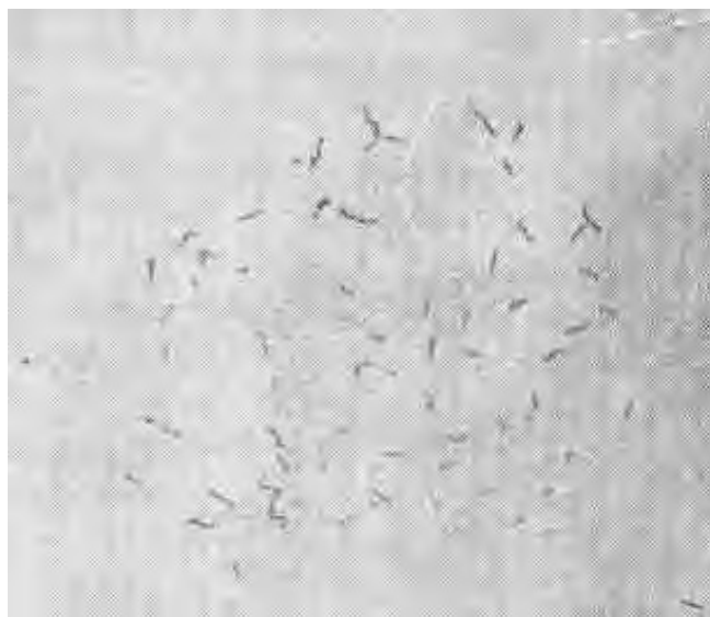
Рисунок 3.12 – Флокены в прокате из слитка легированной стали
