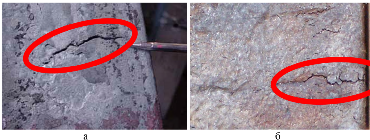
Рисунок 6.6 – Поперечная трещина на поверхности заготовки (а) и угловая поперечная трещина (б)
