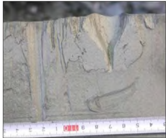
Рисунок 6.1 – Внешний вид травмированной поверхности сляба
