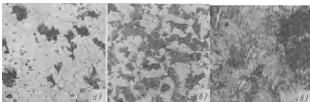
а - феррит и углерод отжига; б - феррит + перлит + углерод отжига (x200); в - перлит и углерод отжига (x300)
