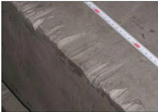
Рисунок 6.1 – Внешний вид травмированной поверхности сляба
