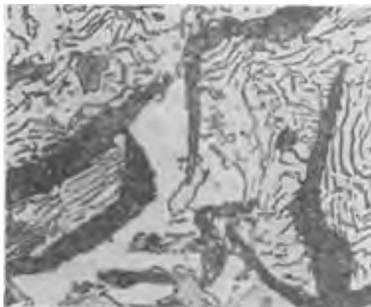
Рисунок 2.18 – Феррито-перлитный серый чугун - феррит + перлит и пластинчатый графит
