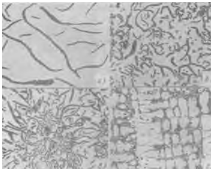
а - прямолинейные; б - завихренные; в - розеточные; г - междендритные Рисунок 2.16 – Включения пластинчатого графита. Шлифы нетравленные (x100)
