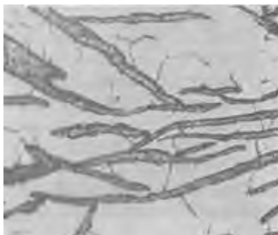
Рисунок 2.17 – Ферритный серый чугун - феррит и пластинчатый графит
