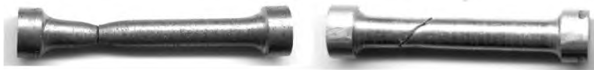
Рисунок 3.4 – Более пластичный и более хрупкий образцы после испытания на растяжение
