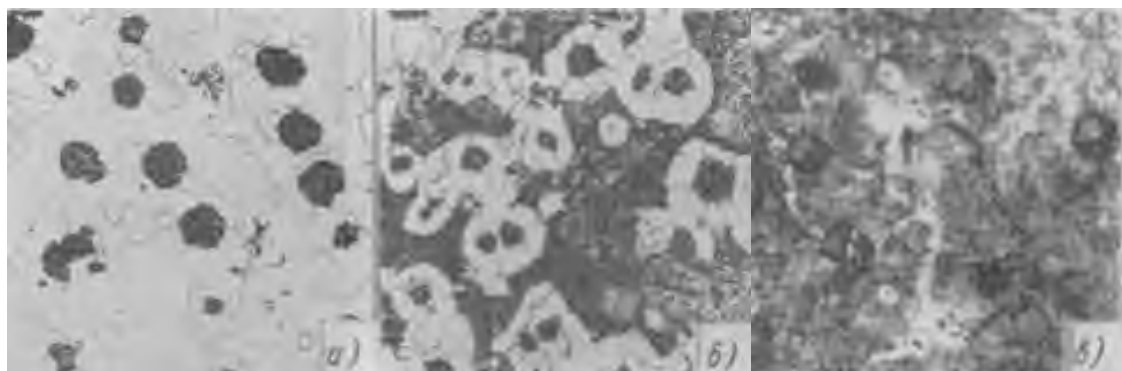
а - феррит и шаровидный графит; б - феррит + перлит + шаровидный графит; в - перлит и шаровидный графит
