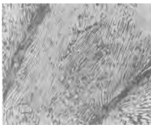
Рисунок 2.19 – Перлитный серый чугун - перлит+пластинчатый графит
