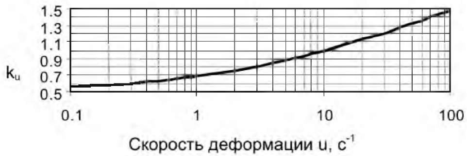
Рисунок В.2 – Термомеханические коэффициенты для стали 40X
