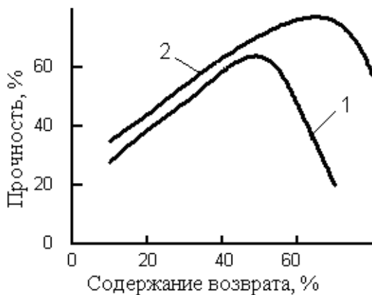
Рисунок 3.2 – Влияние содержания возврата в шихте на прочность агломерата при различном содержании углерода: 1 – 6%; 2 – 10%
