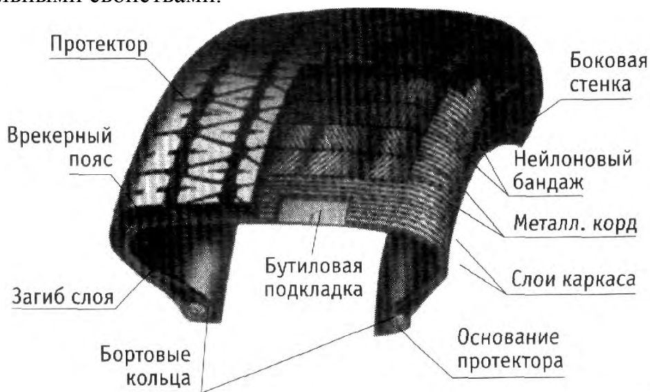
Рисунок 8.2 – Структура автомобильной покрышки
