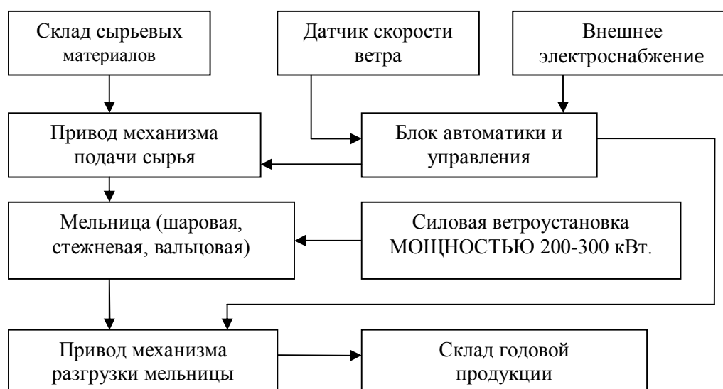
Рисунок 4.5 - Схема автоматической ВЭУ для производства полуфабрикатов строительных материалов
