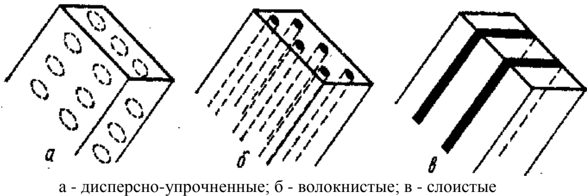
Рисунок 15.1 - Схема строения композиционных материалов по типу упрочняющих наполнителей
