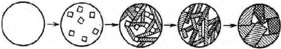
Рисунок 14.6 - Схема кристаллизации стекла при образовании ситаллов с помощью катализаторов
