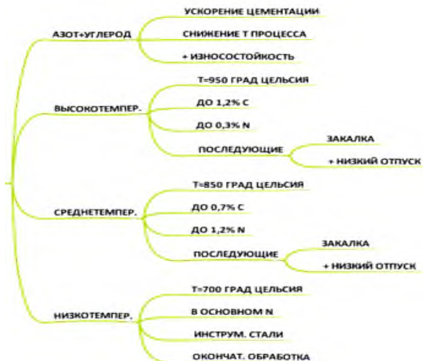
Рисунок 12.11 – Схема технологического процесса нитроцементации стали
