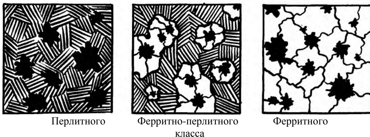
Рисунок 10.3 - Микроструктура ковкого чугуна на ферритной основе.
