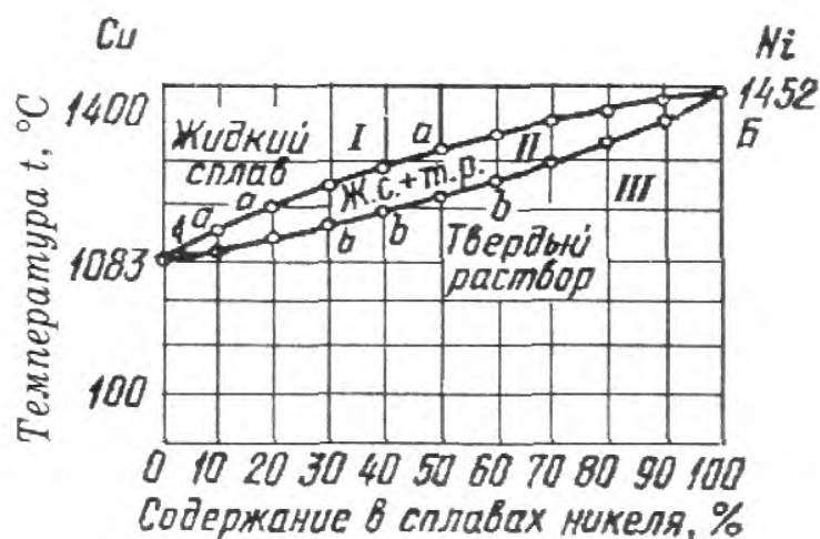
Рисунок 5.3 - Диаграмма состояния сплавов Cu–Ni второго рода
