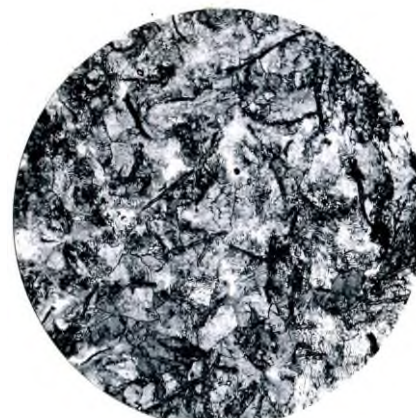
Серый чугун (3,40 % C; 0,65 % Mn; 1,95 % Si; 0,119 % S; 0,180 % P) (графит на перлитной основе)
