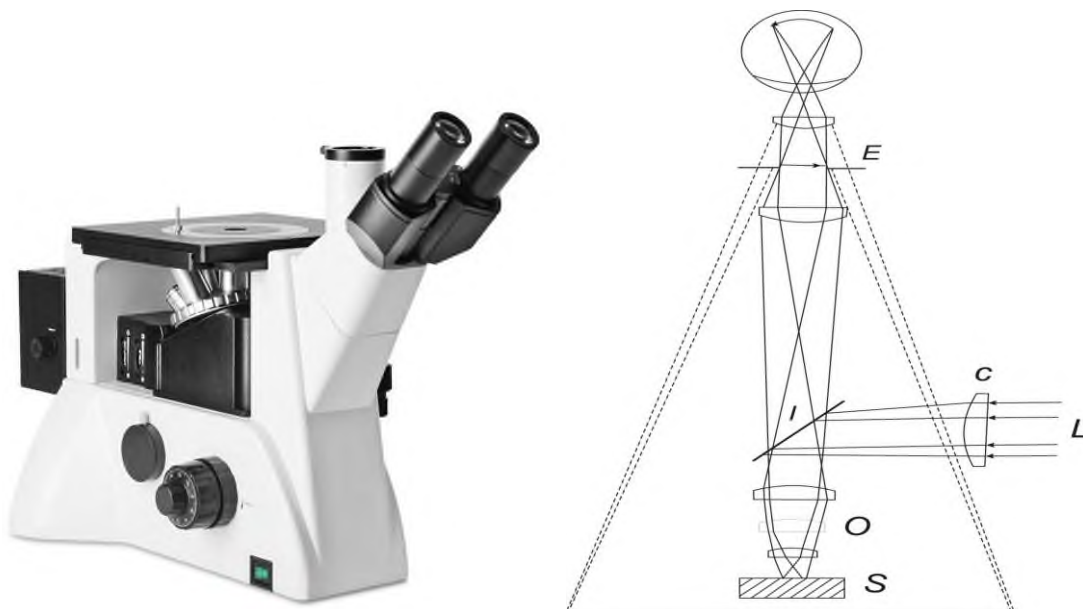
Рисунок 1.1 - Схема работы оптического микроскопа
