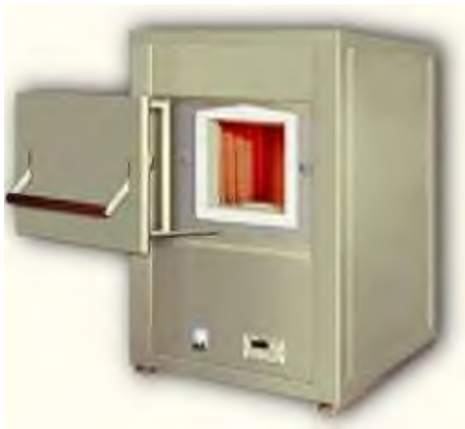
Рисунок 3.4 – Камерная лабораторная печь сопротивления СНОЛ 12/16
