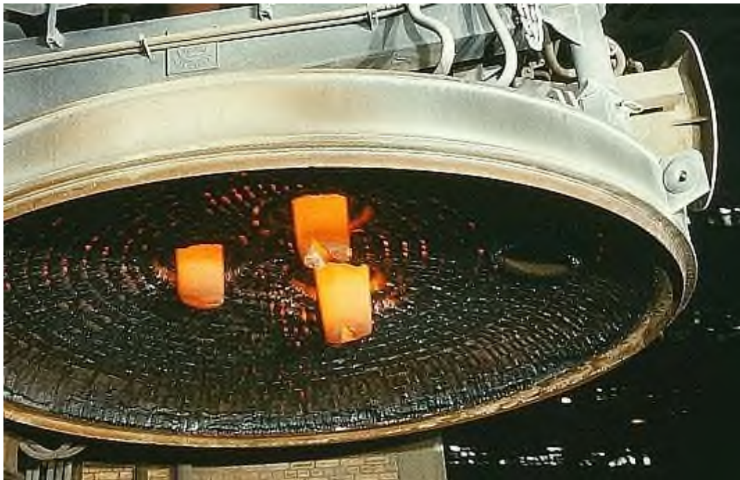
Рисунок 1.6 – Водоохлаждаемый свод печи ДСП-100
