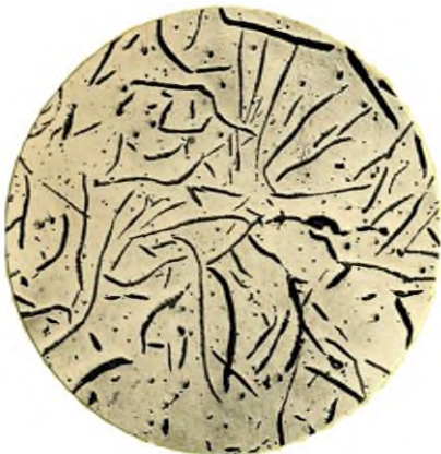
Серый чугун (3,4% C; 0,83% Mn; 2,54% Si; 0,084% S; 0,340 % P) (графит на ферритной основе)
