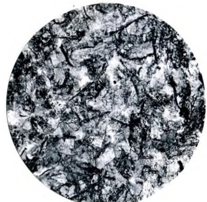
Серый чугун (3,40% C; 0,65% Mn; 1,95% Si; 0,119% S; 0,180 % P) (графит на перлитной основе)
