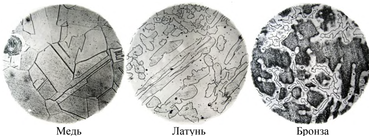
Рисунок 6.1 - Микроструктуры меди и сплавов на её основе (×500)
