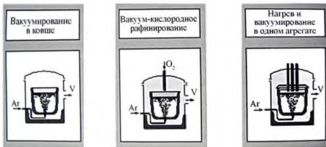
Рисунок 5.6 – Способы ковшевого вакуумирования стали
