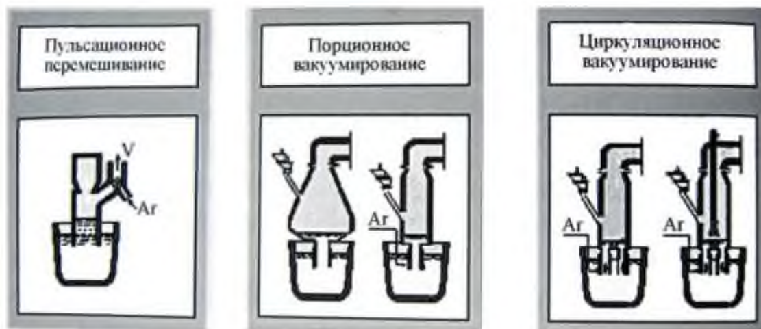
Рисунок 5.3 – Способы вакуумирования стали в вакуум-камере
