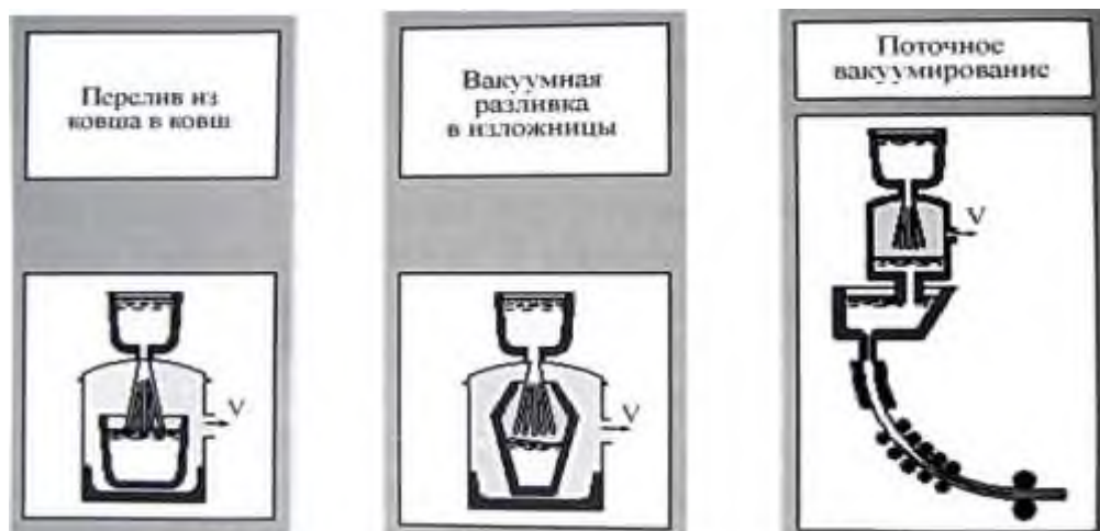
Рисунок 5.2 – Способы струйного вакуумирования стали
