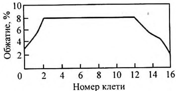
Рисунок 100 – Распределение обжатий по клетям редукционного стана [14]
