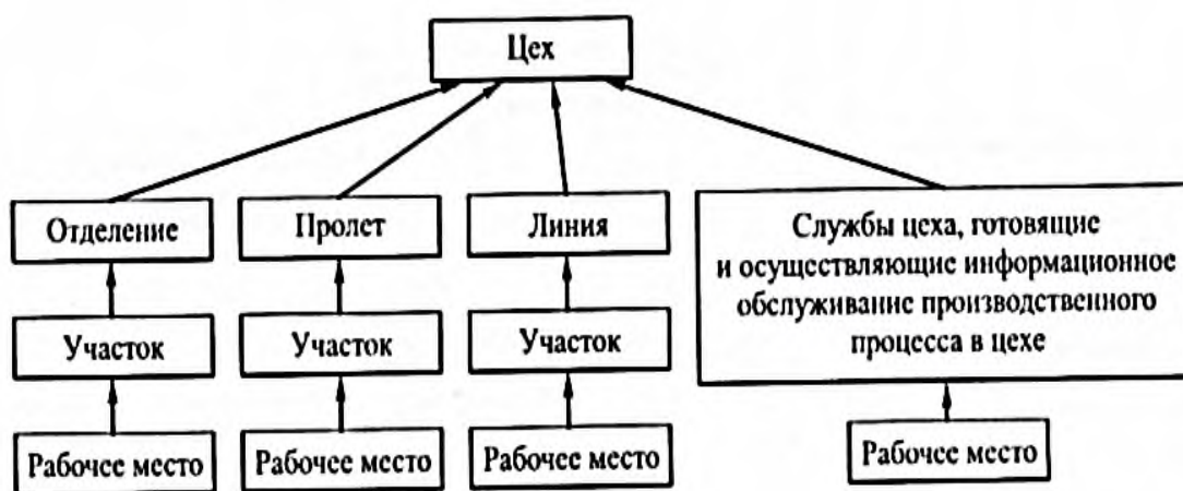
Рисунок 24 – Производственная структура цеха [9]
