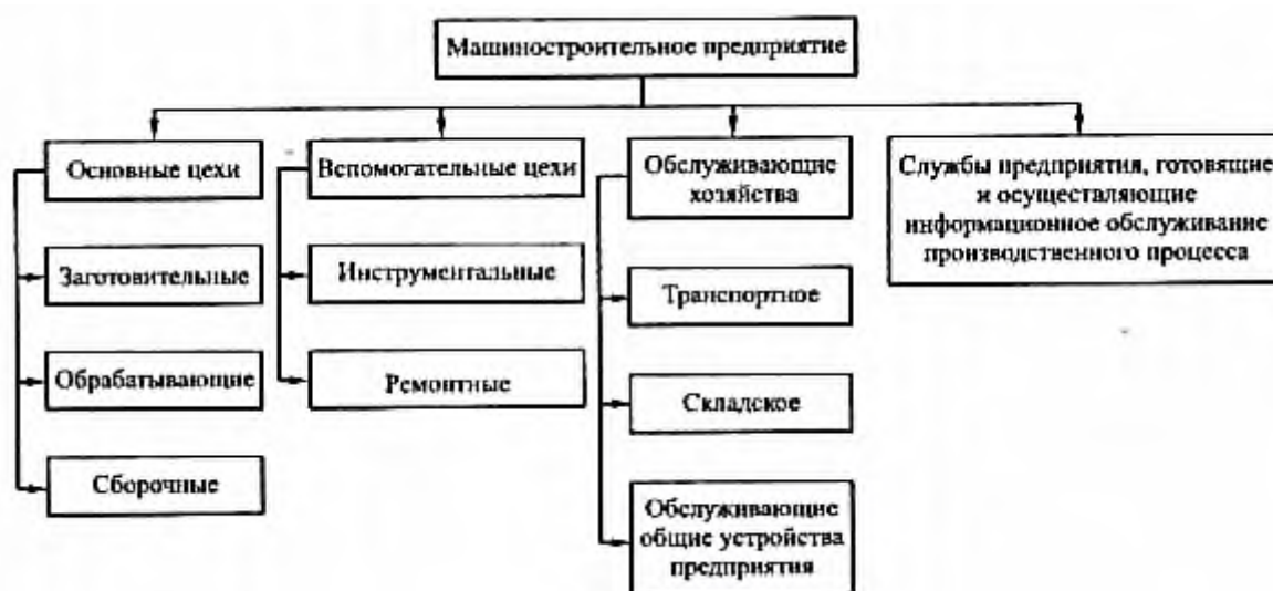
Рисунок 22 – Производственная структура машиностроительного предприятия [9]
