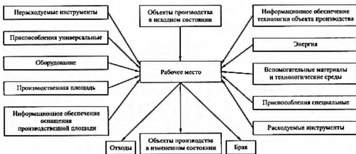
Рисунок 23 – Средства оснащения и функции рабочего места [9]
