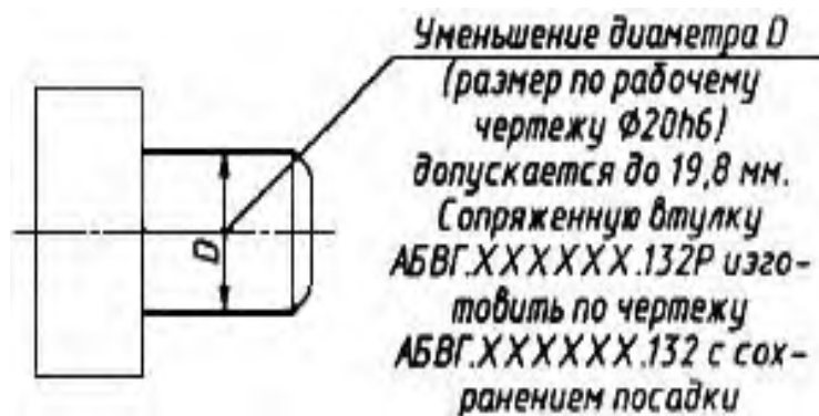
Рисунок 10 – Пример изображения исчерпывающего указания об изготовлении сопряженного изделия по рабочей конструкторской документации, включенной в комплект документов для ремонта
