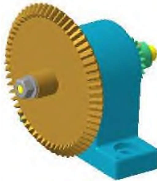
Рисунок 44 – Совпадение соответствующих торцевых поверхностей
