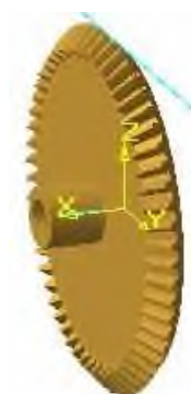
Рисунок 26 – Коническая поверхность зубчатого венца
