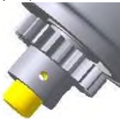
Рисунок 38 – Отверстие под штифт
