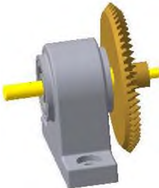
Рисунок 37 – Установка конического зубчатого колеса на вал
