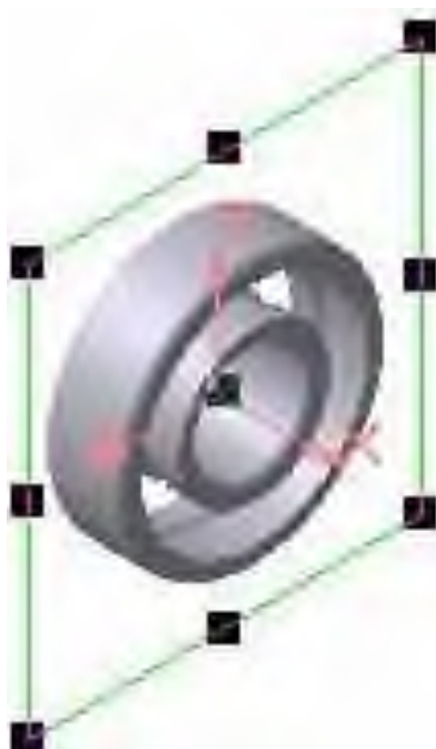
Рисунок 14 – Плоскость построения эскиза
