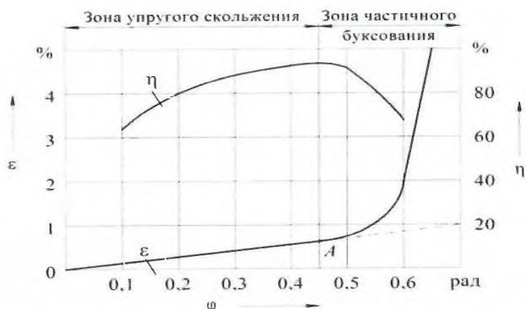
Рисунок 6.3 – Типовые кривые коэффициента упругого скольжения \varepsilon и КПД в зависимости от коэффициента тяги \varphi
