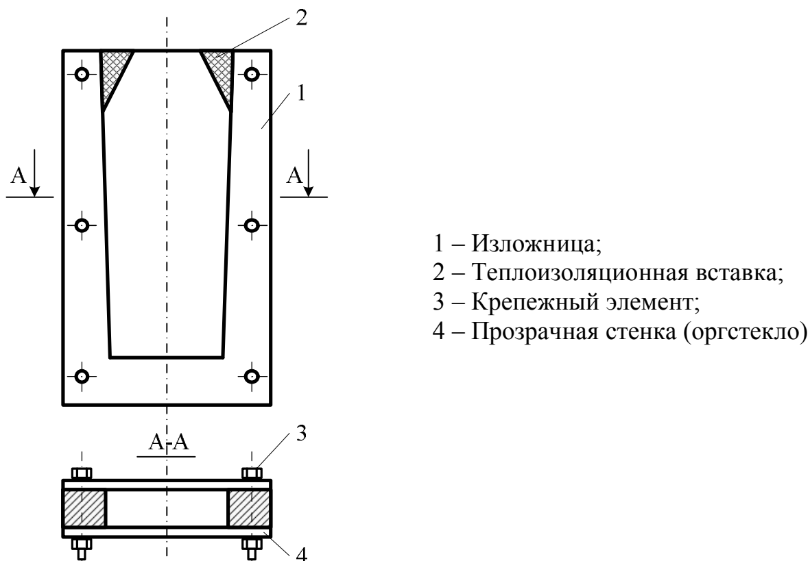
Рисунок 7.2 – Модель плоской прозрачной изложницы
