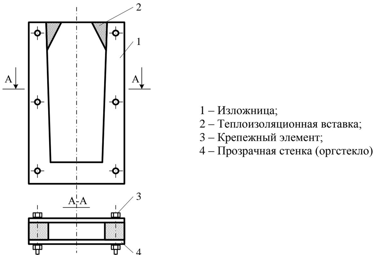
Рисунок 1.2 – Модель плоской прозрачной изложницы
