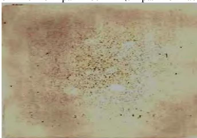
Рисунок 6.2 – Серый отпечаток поперечного темплета блюмовой заготовки с дефектом «Осевая химическая неоднородность»
