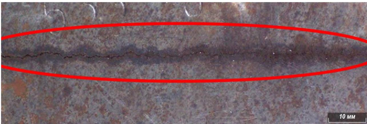
Рисунок 6.4 – Макроструктура дефекта «осевая трещина»
