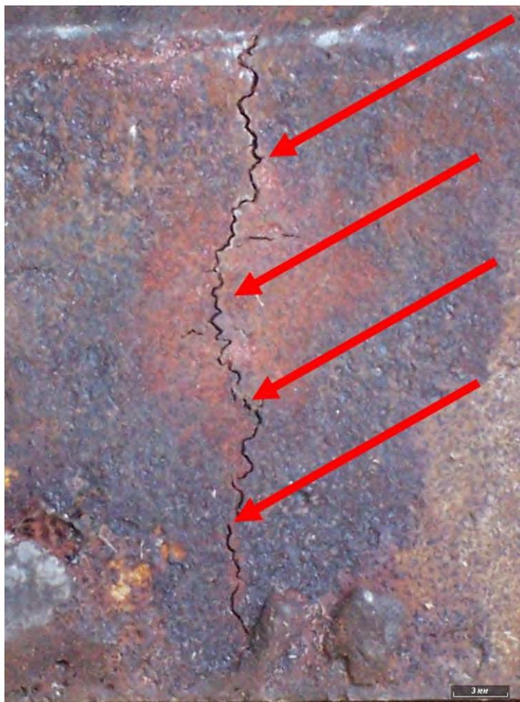
Рисунок 6.5 – Макрофотография дефекта «Продольная трещина»
