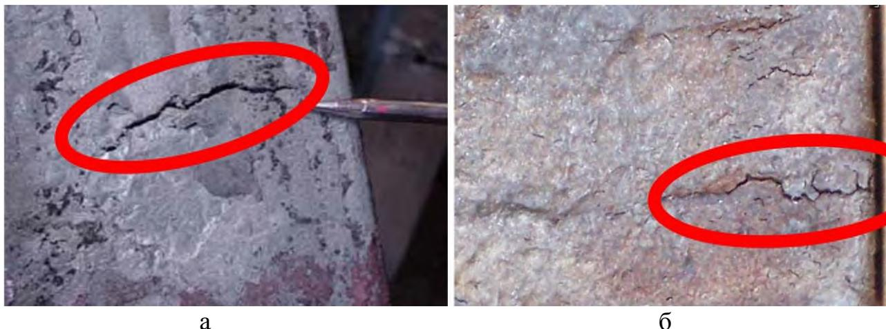
Рисунок 6.6 – Поперечная трещина на поверхности заготовки (а) и угловая поперечная трещина (б)
