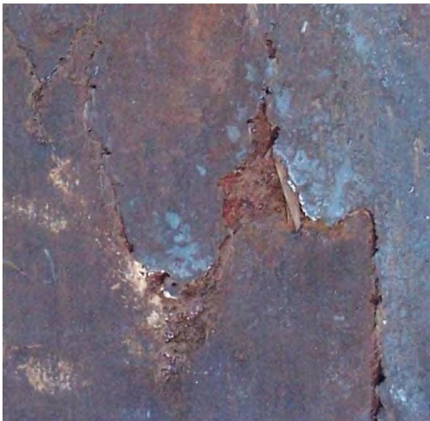
Рисунок 6.9 – Макрофотография дефекта «Гнездообразная трещина»
