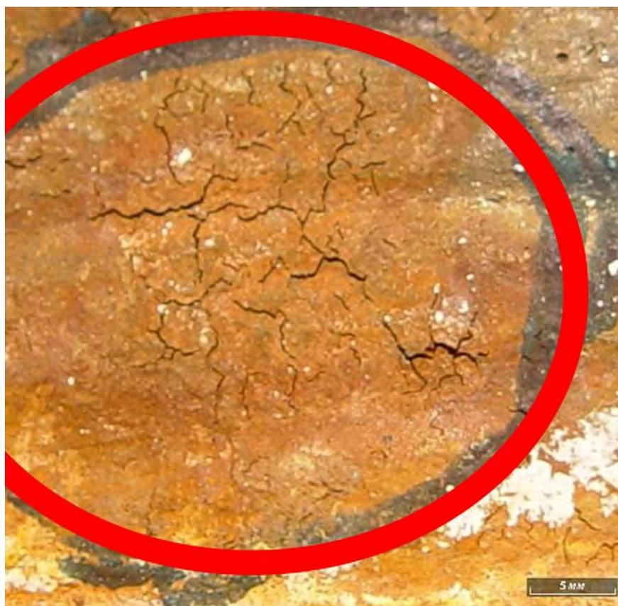
Рисунок 6.7 – Макрофотография дефекта «Паукообразная трещина»
