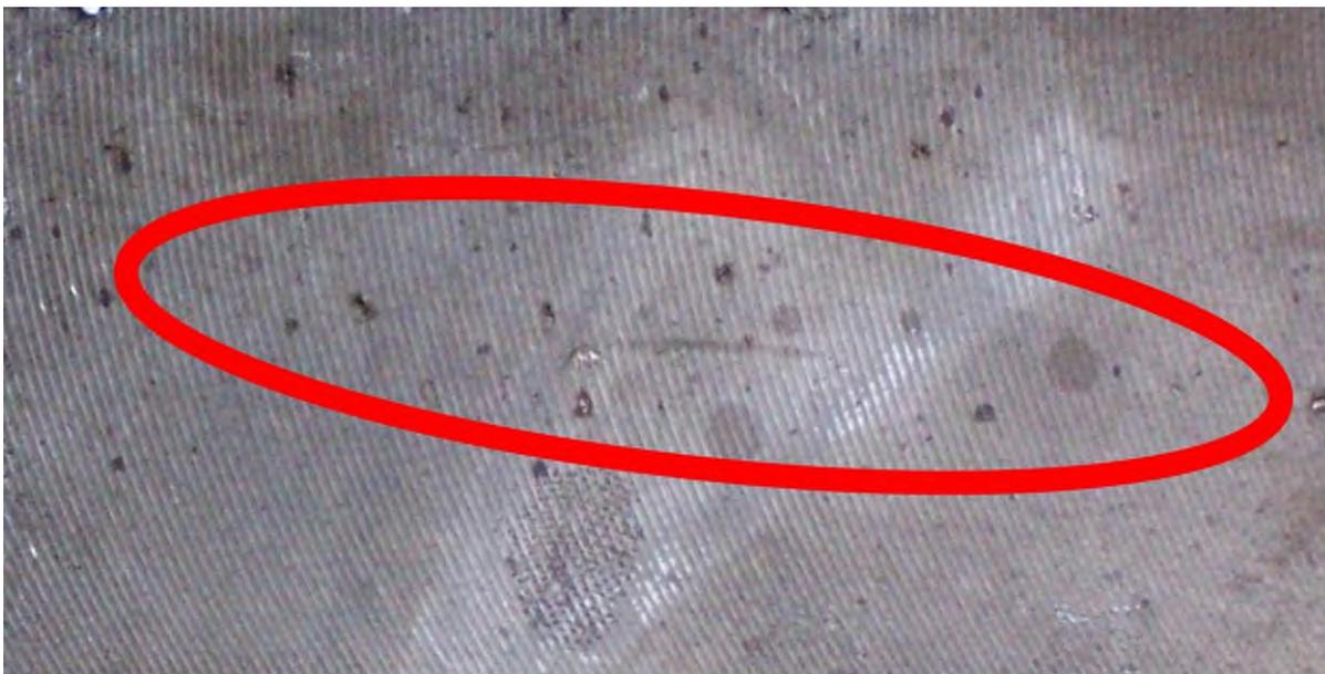
Рисунок 6.11 – Макрофотография дефекта «Точечная неоднородность»
