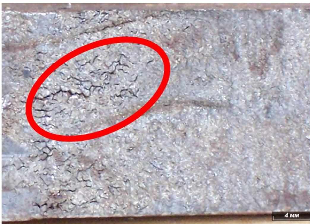
Рисунок 6.8 – Макрофотография дефекта «Сетчатая трещина» на слябовой заготовке
