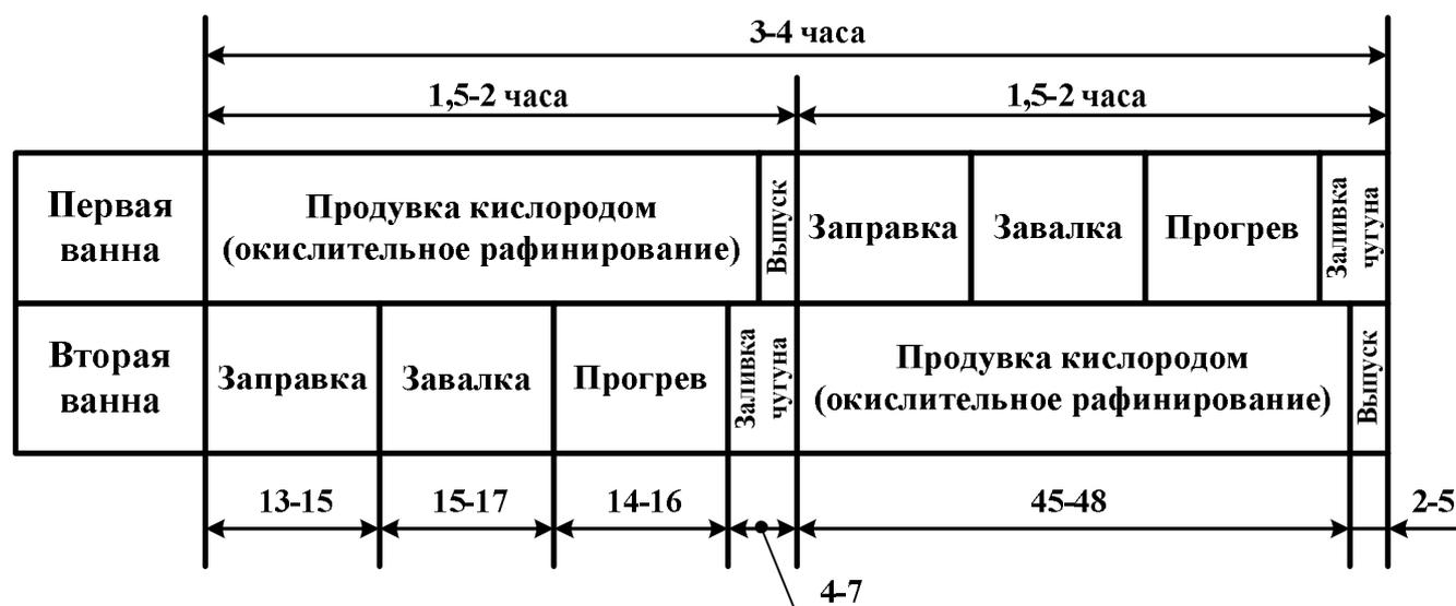
Рисунок 29 – График совмещения операций при плавке стали в двухваннных печах и примерная их продолжительность (% от общей длительности плавки)
