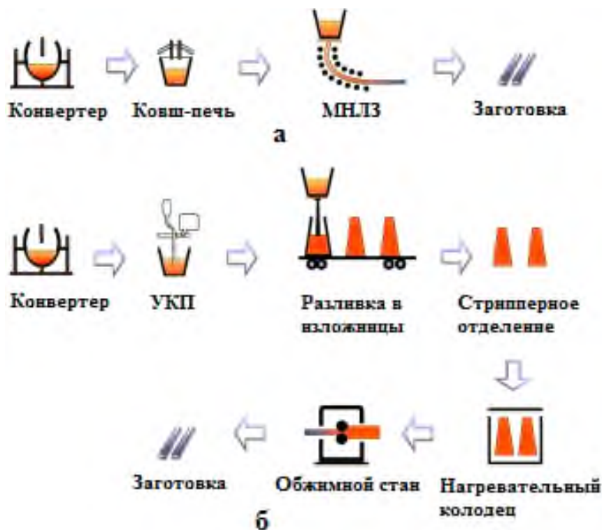
Рисунок 9 – Технологическая схема производства стальной заготовки при непрерывной (а) разливке и разливке в изложницы (б)
