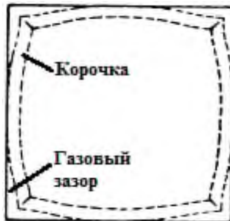
Рисунок 10 – Схема деформации корки НЛЗ при формировании газового зазора
