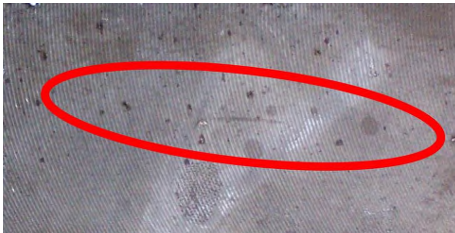
Рисунок 50 – Макрофотография дефекта «Точечная неоднородность»
