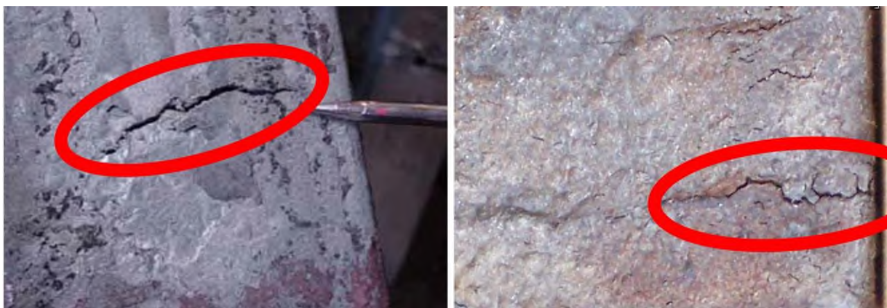
Рисунок 46 – Поперечная трещина на поверхности заготовки (а) и угловая поперечная трещина (б)
