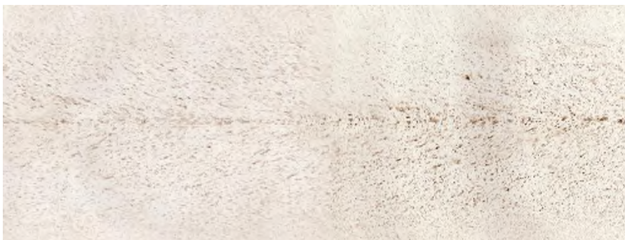
Рисунок 42 – Серный отпечаток продольного сечения НЛЗ с осевой ликвацией
