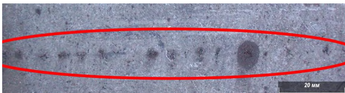
Рисунок 41 – Макрофотография дефекта «Осевая рыхлость»
