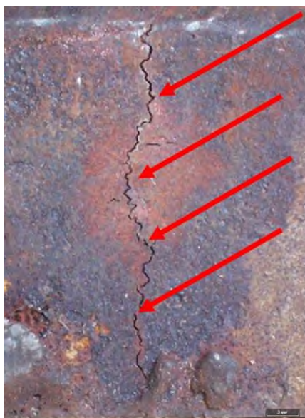
Рисунок 45 – Макрофотография дефекта «Продольная трещина»
