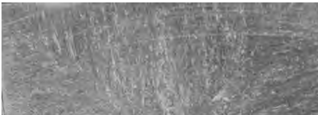
Рисунок 49 – Травленный темплет с дефектом «Ликвационные полоски»
