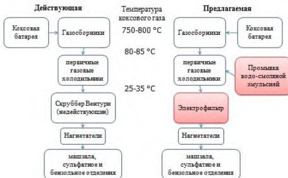
Рис.1 Действующая и предлагаемая схема первичного охлаждения коксового газа КХП АО «Уральская Сталь»
