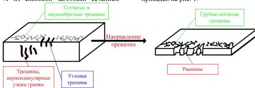
Рис. 1. Трансформация дефектов непрерывнолитой заготовки при продольной прокатке
