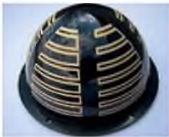
Рис. 2. Объемная плата СВЧ антенны
