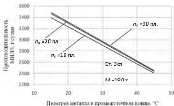
Рис. 3. Зависимость суточной производительности машины от перегрева стали марки Ст. 3сп в промежуточном ковше и количества плавков в серии ( n_c ) при разливке металла открытой струей
