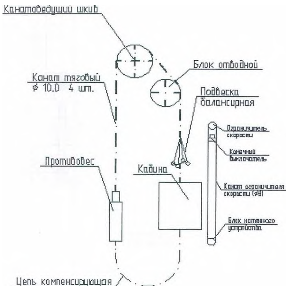
Рис. 1. Кинематическая схема подъемника
