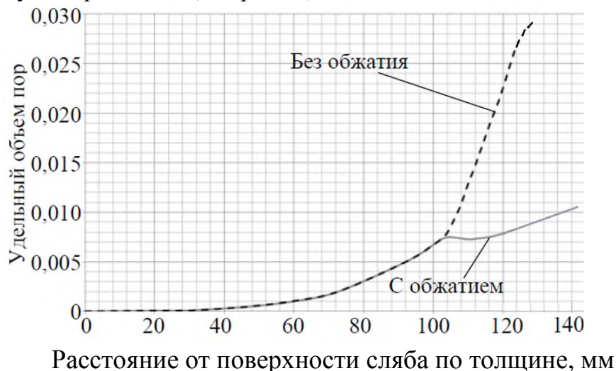
Рис. 1. Распределение удельного объема пор в непрерывнолитой заготовке толщиной 270 мм, отлитой с «мягким» обжатием и без него
