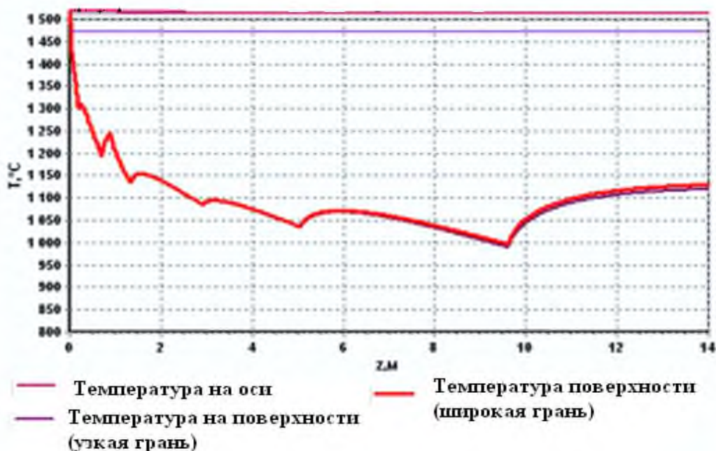
Рис. 1. Зависимость температуры поверхности заготовки по ее длине для сортовой заготовки 150×150 мм, скорость 3 м/мин.
