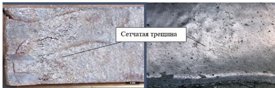
Рисунок 1 – Внешний вид дефекта на поверхности НЛЗ
