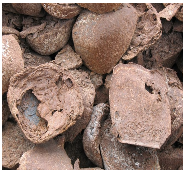
Рисунок 1 – Наплывы на чушковом чугуне
