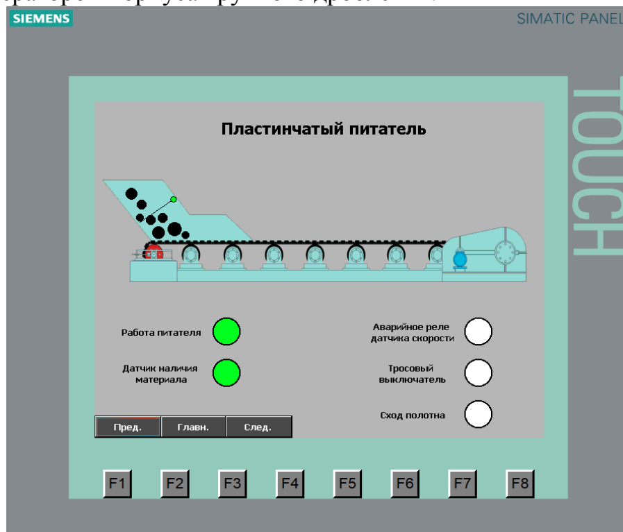
Рисунок 2 – Окно контроля питателя на HMI-панели
