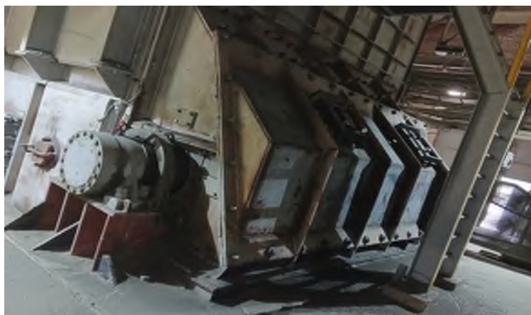
Молотковая дробилка клинкера KB 1300 x 3000
