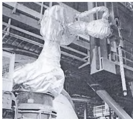
Рис. 3 – Роботизированная система «LiquiRob» для отбора зондовых проб [5]
