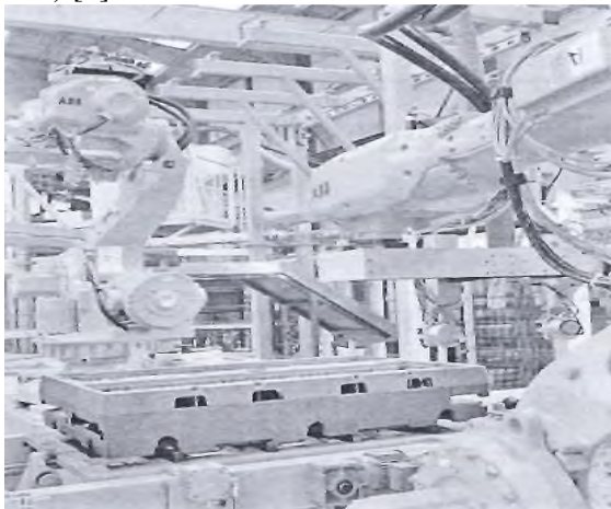
Рис. 1 – Роботизированная линия производства и сборки стержней в пакеты, предназначенные для изготовления чугунных отливок «головка блока цилиндров» [3]
