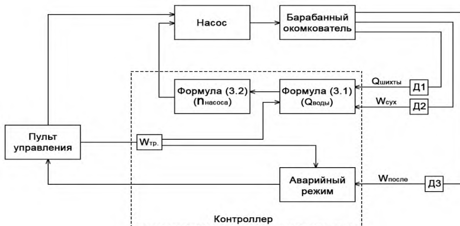
Рис. 1 – Функциональная схема автоматического регулирования
