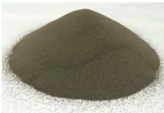
Рис.1. Наплавочный порошок, Патентом на изобретение 2657968 «Порошковый сплав для изготовления объемных изделий методом селективного спекания».
