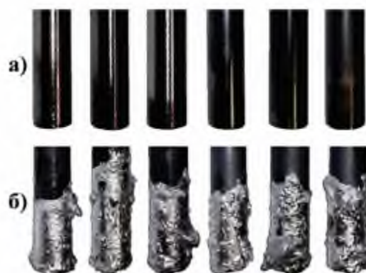
Рис. 2 – Экспериментальные образцы с покрытием: а) до погружения в расплав; б) извлеченные из контейнера с расплавом
