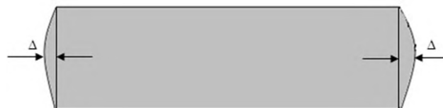
Рис. 1 - Схематичное изображение выпуклости величиной \Delta узких граней непрерывнолитого сляба в поперечном сечении
