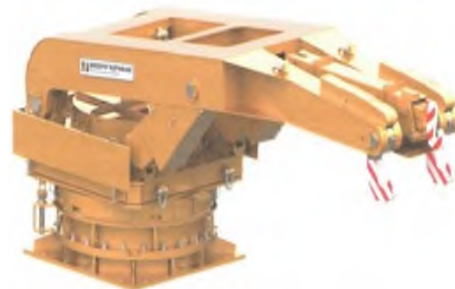
Рис. 2 – Манипулятор съема крышек главных желобов конструкции компании «Днепрогидромаш» [4]
