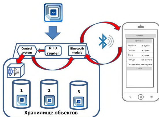
Рис. 1 Функциональная схема системы хранения
