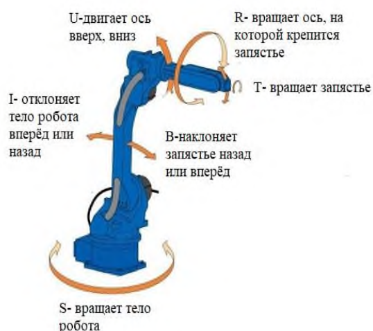
Рис. 1. Шестиосевой промышленный робот
