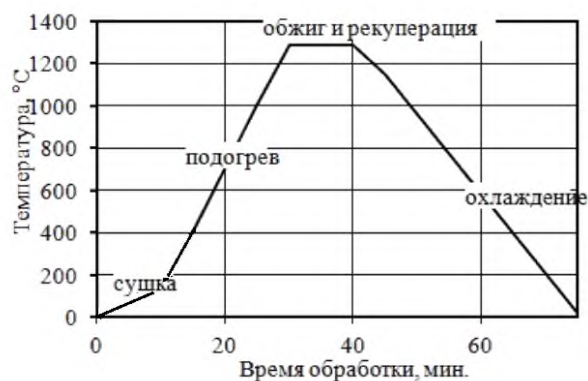
Рис. 1. Технологический режим обжига опытных окатышей
