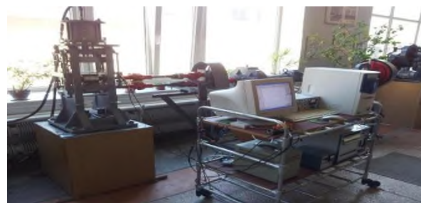
Рис. 1. Лабораторный прокатный мини-стан 100x100 [1]
