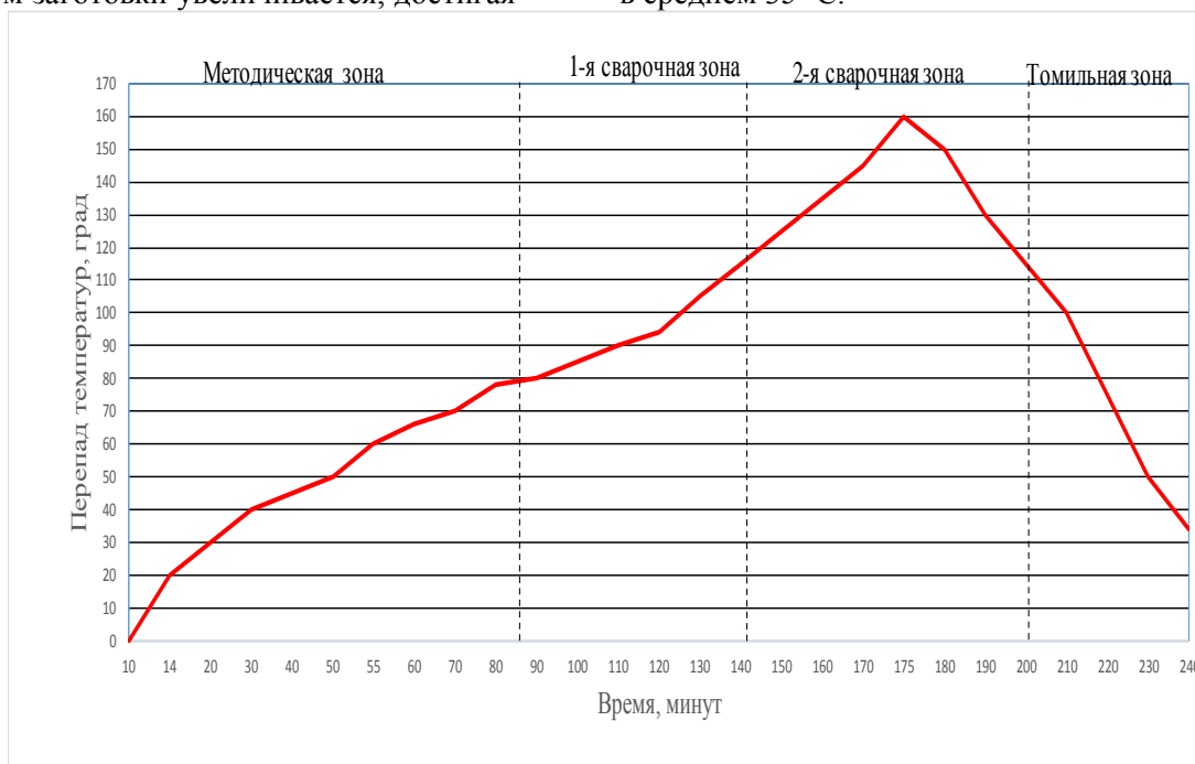
Рис. 2. Изменение перепада температур по сечению сляба
