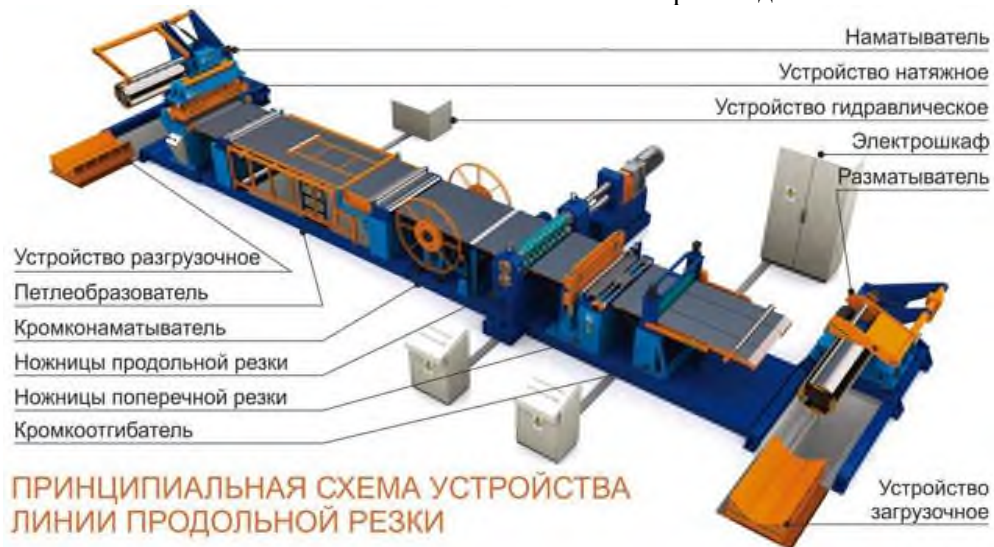
Рис.2 - Принципиальная схема устройства линии продольной резки
