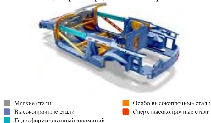
Рис. 1. Распределение различных видов стали в кузове автомобиля
