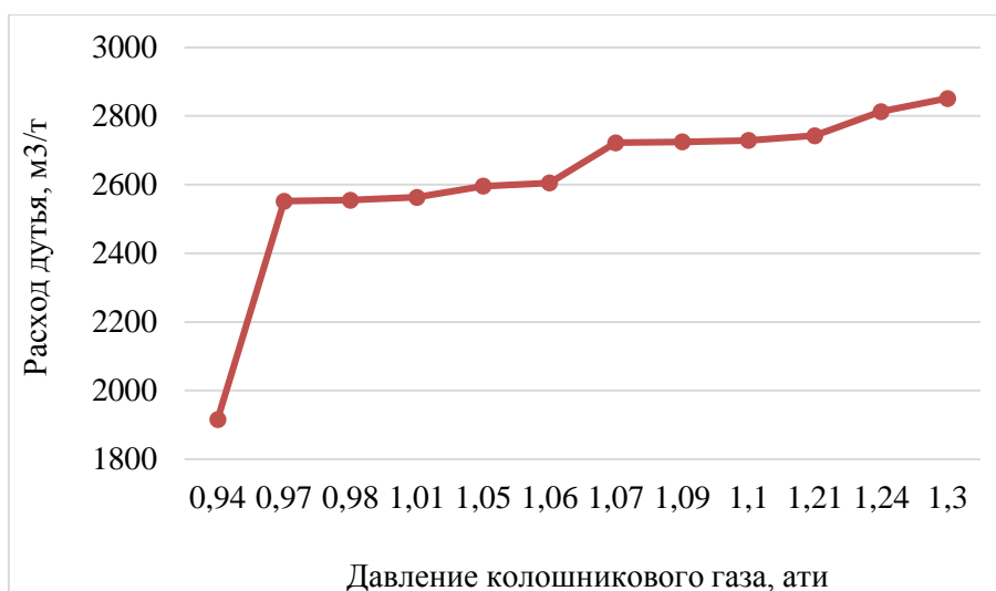
Рис. 4 – Зависимость расхода дутья от давления колошникового газа
