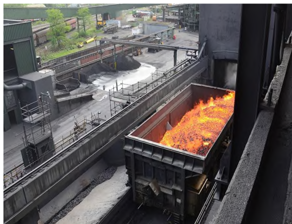
Рис. 3 – Тушильный вагон батареи классического слоевого коксования
