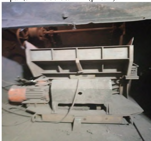
Рис. 1 – Коксовый грохот до модернизации
