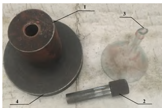
Рисунок 1. Лабораторные приспособления для грануляции сыпучих материалов: 1-матрица, 2-пуансон, 3-приемная воронка и 4-нижний пуансон
