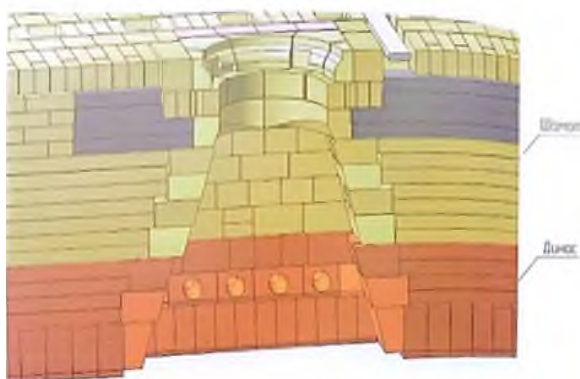
Рис.2 – Фрагмент кладки загрузочного люка коксовой батареи
