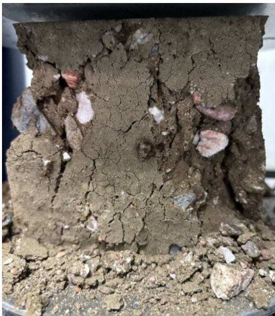
Рис. 7 – Образец бетона после испытания на сжатие
