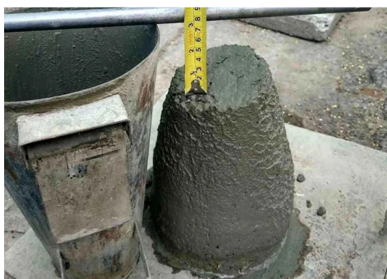
Рис. 2 – Измерение осадки конуса
