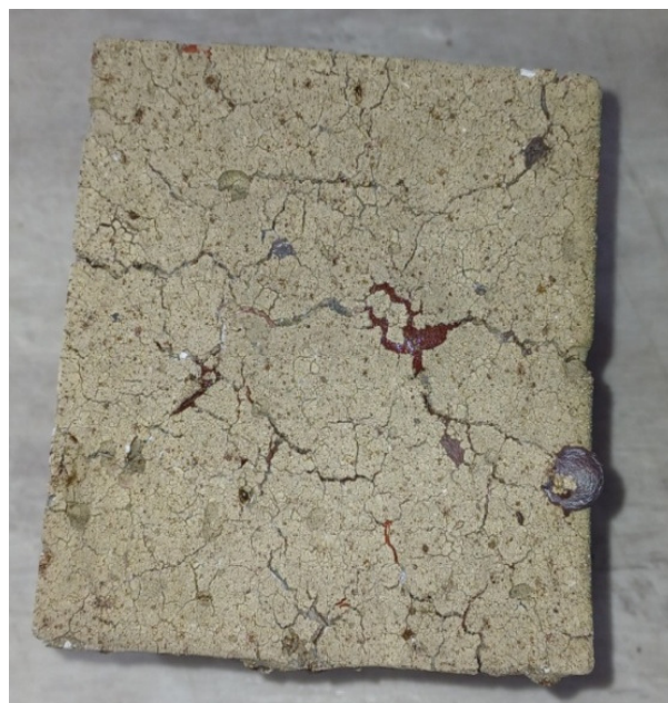
Рис.5 – Образец бетона после термообработки
