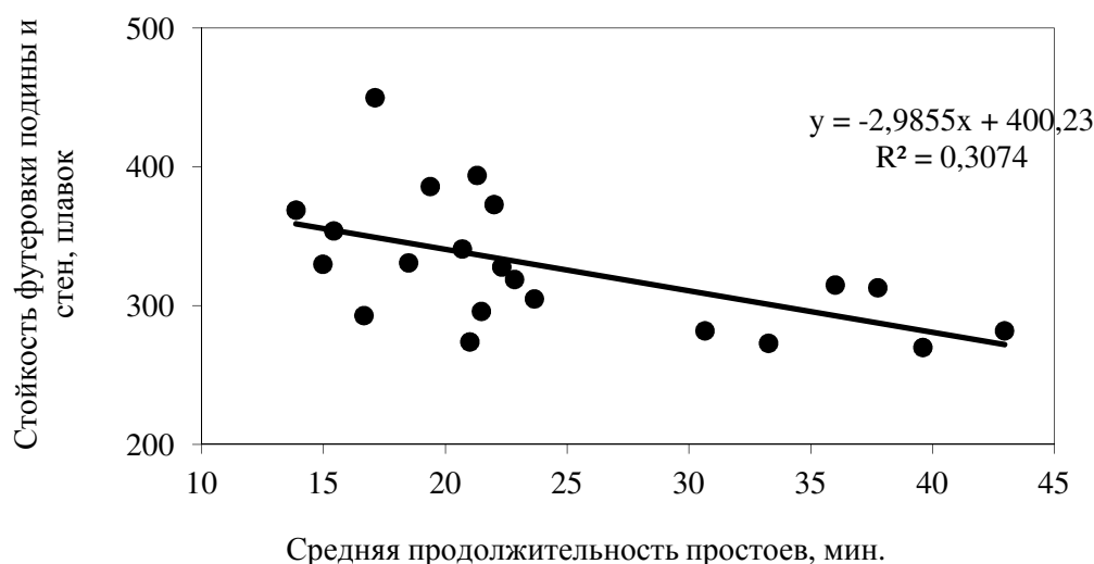
Рис. 1. Влияние длительности простоев на стойкости футеровки подины и стен [11]
