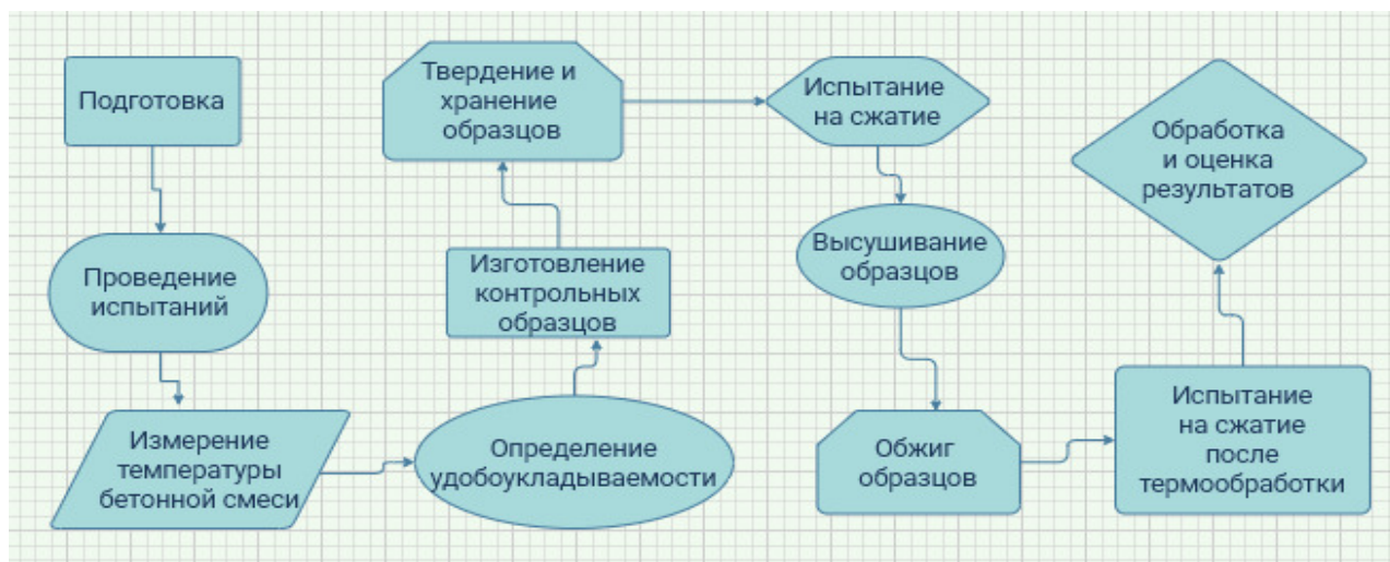
Рис. 1 – Порядок проведения испытаний в лабораторных условиях ООО «АККЕРМАНН ЦЕМЕНТ»
