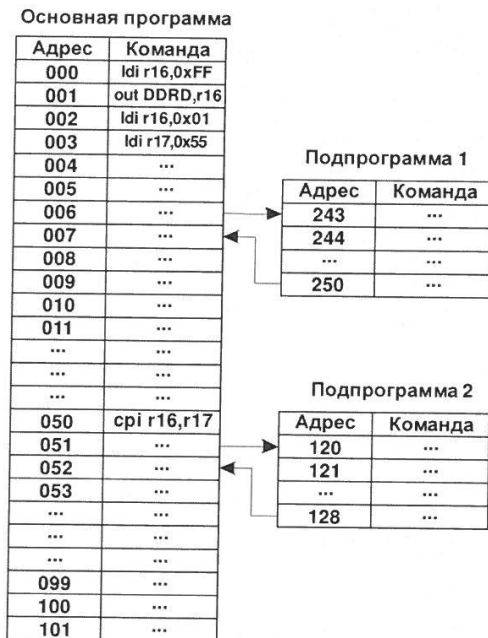
Рис. 1. Принцип работы указателя стека
