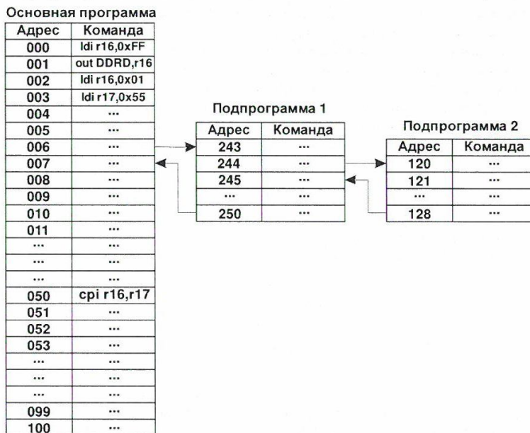
Рис. 2. Принцип заполнения стека
